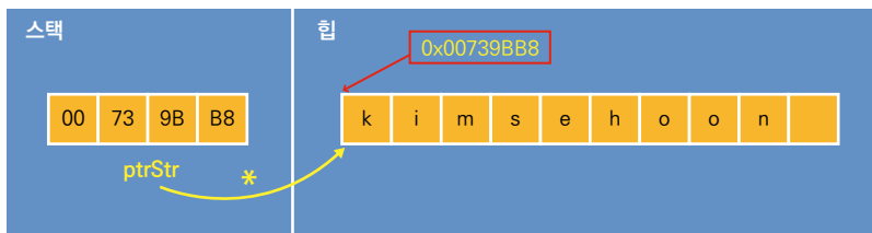
그림 2-8 malloc() 함수에 의한 ptrStr 지역 변수의 메모리 구조
